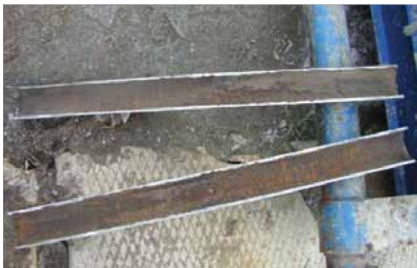
Рис. 4. Пример коррозированной НКТ в интервале 2208-2112
