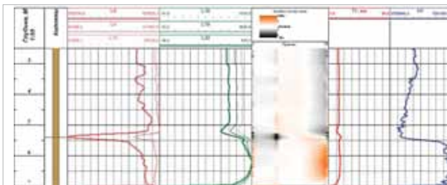
Рис. 2. Запись на моделях. Локализация поперечного разрыва 73-миллиметровой колонны
