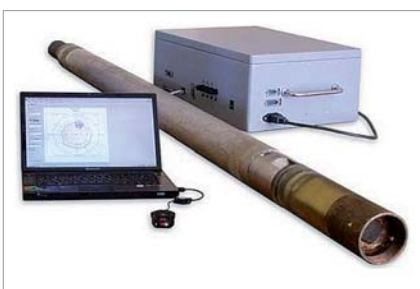
Рис. 1. Звуколокационный регистрирующий комплекс ЛАС
